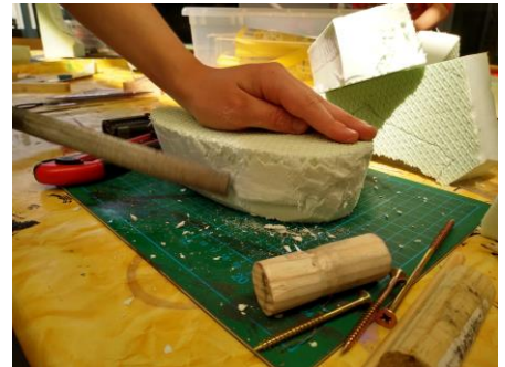
Foto 1: Bearbeiten des Styrodorrumpfs mit einer Feile
